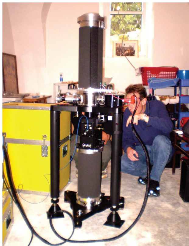
Слика 2. Мерење апсолутног убрзања у манастиру инструментом FG5
